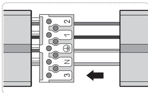
Произвести подключение следующего светильника в линии:
