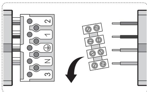
Снять винтовую колодку с магистральных проводов
